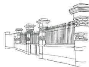
Grilles de clôture en ferronnerie, piles (pilier constitué de petits éléments maçonnés) en pierre de taille et brique, mur bahut en moellon calcaire
