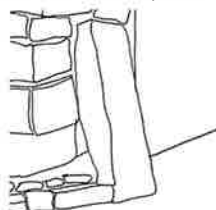
Borne en pierre adossée à un mur de clôture
